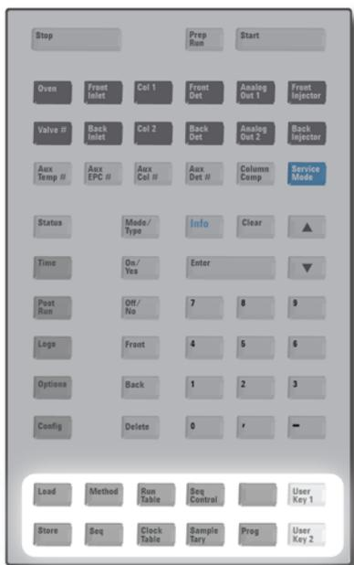
Estas teclas sirven para cargar y almacenar métodos y secuencias localmente en el GC. No se pueden utilizar para acceder a los métodos y secuencias almacenados por el sistema de datos de Agilent.
