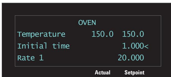
El cursor, <, muestra la línea actualmente activa. Utilice las teclas de desplazamiento para seleccionar otra línea en la pantalla y para ver líneas adicionales en la pantalla.
