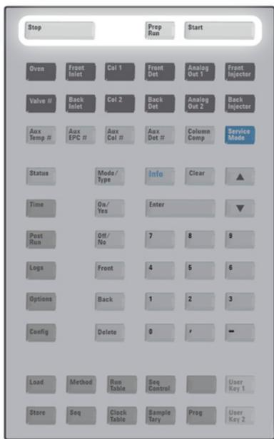
**[Prep Run]** Activa los procesos necesarios para poner el GC en las condiciones de inicio que dicte el método (como por ejemplo cerrar el flujo de purga del inyector para una inyección sin división (splitless) o restablecer el flujo normal desde el modo de ahorro de gas). Consulte el [Manual Advanced Operation](#) para obtener más detalles.
