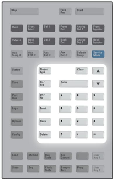
**[Mode/Type]** Proporciona acceso a una lista de parámetros posibles asociados con los ajustes no numéricos de un componente. Por ejemplo, si el GC está configurado con un inyector con y sin división se pulsa la tecla **[Mode/Type]**, las opciones que aparecerán en la lista son split, splitless, pulsed split o pulsed splitless.
